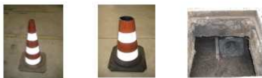
Coni da utilizzare in ingresso - uscita delle tubazioni per la posa/recupero dei cavi
